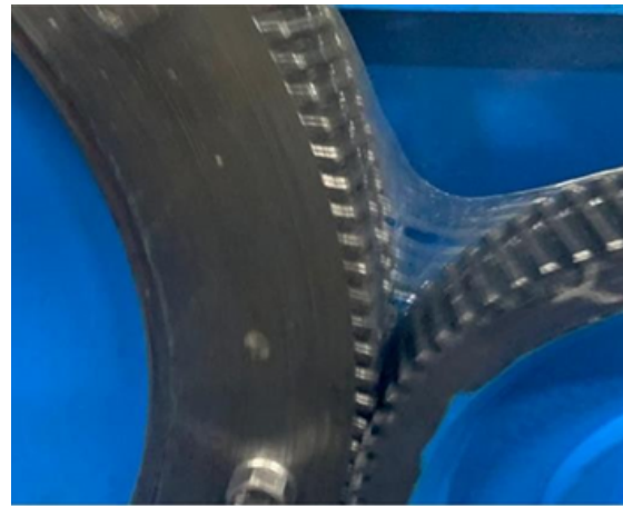
FIGURA 2(b) Engranajes abiertos de un Molino de bolas
