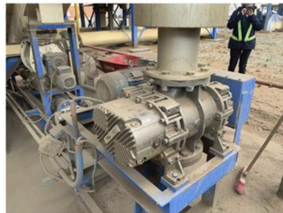
FIGURA 3(c) Soplador de lóbulos cuyos engranajes y rodamientos trabajan bajo condiciones de Fricción fluida y lubricación hidrodinámica (LHD)
